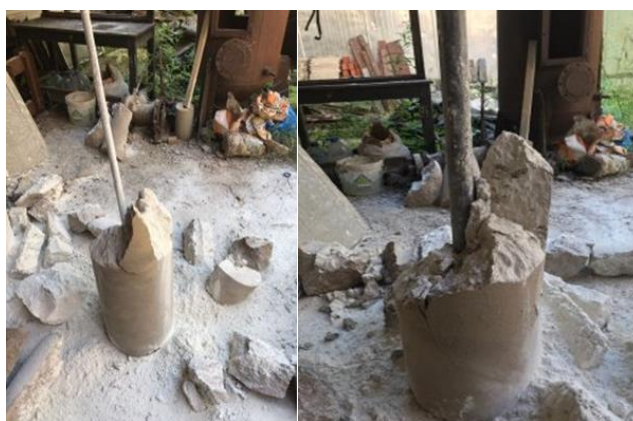
Рисунок 5. Результаты разрушений бетонных моделей при полигонных испытаниях
