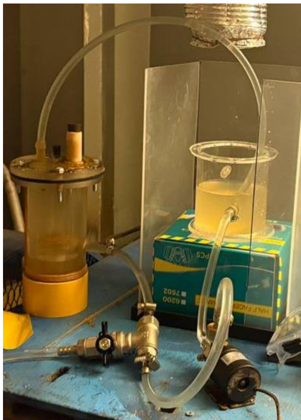
Рисунок 2. Процесс выщелачивания песчаных пород в массообменном аппарате
