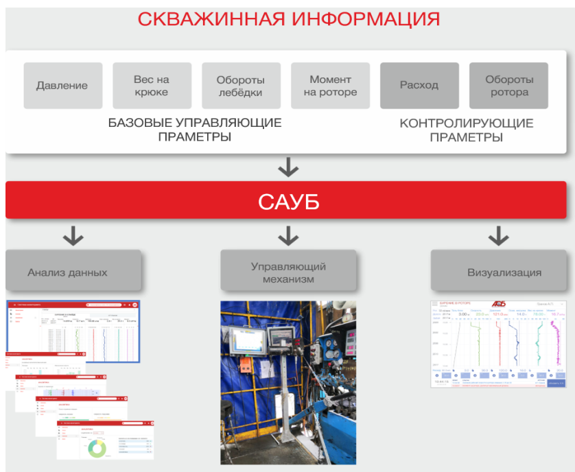
Рисунок 1. Принцип действия системы автобурения
