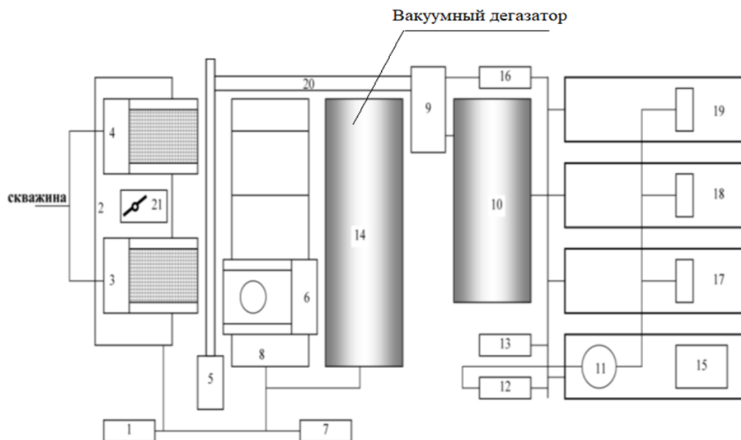
Рисунок 2. Принципиальная схема расположения бурового оборудования по очистке бурового раствора при бурении по безамбарной технологии
