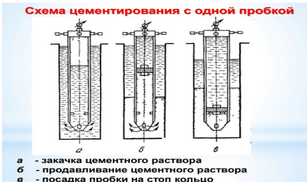
Рисунок 1. Схема цементирования с одной пробкой
